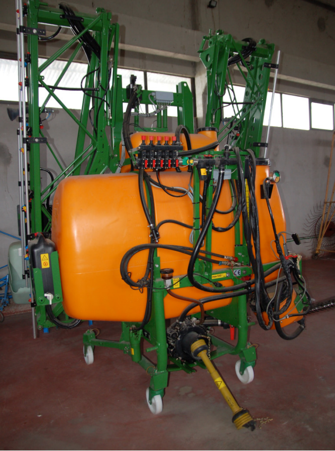
Εικόνα 5.18 Το αναρτώμενο ψεκαστικό απαιτεί περιστροφή από το P.T.O. του γεωργικού ελκυστήρα (για την κίνηση της αντλίας του ψεκαστικού υγρού) και υδραυλική ενέργεια για τη διάταση των συμπτυγμένων τμημάτων του ιστού ψεκασμού.
