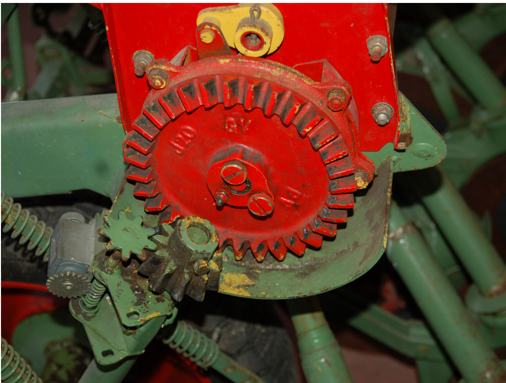
Εικόνα 5.1 Γωνιακή μετάδοση με αντίστοιχη διαμόρφωση των οδοντοτροχών σε σπαρτική σιτηρών και μικρών σπόρων, στην οποία μπορεί να αλλάξει η ταχύτητα κίνησης.
