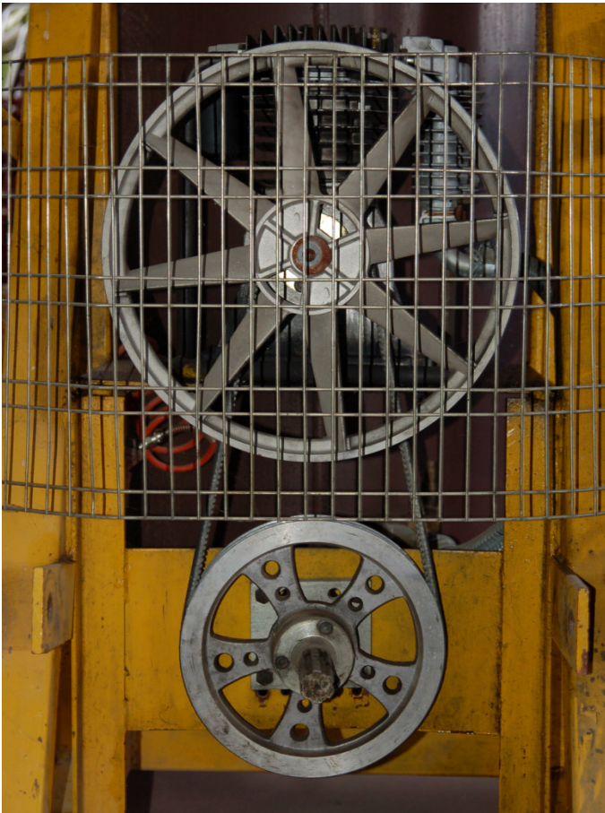
Εικόνα 5.6 Μετάδοση της κίνησης σε αεροσυμπιεστή ο οποίος αναρτάται στο γεωργικό ελκυστήρα και κινεί αεροψάλιδα για το κλάδεμα οπωρώνων. Η κάτω τροχαλία είναι η κινητήρια [ισχυροδοτείται από τον δυναμοδοτικό άξονα (P.T.O.) του γεωργικού ελκυστήρα (άρα περιστρέφεται με 540 rpm)].
