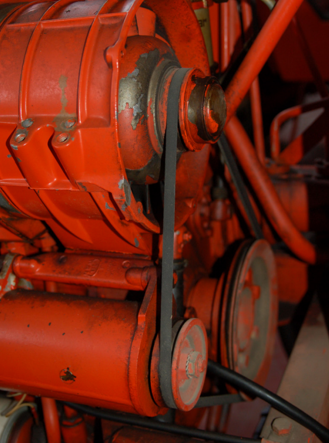
Εικόνα 5.5 Μετάδοση της κίνησης με ιμάντα. Από τις 3 τροχαλίες μόνο η κάτω δεξιά είναι η κινητήρια (στροφαλοφόρος άξονας), ενώ η αριστερή κάτω (κινούμενη) αφορά την ηλεκτρογεννήτρια (ή δυναμό), η οποία παίζει ταυτόχρονα και το ρόλο του τανυστή του ιμάντα, ενώ η επάνω επίσης κινούμενη τροχαλία φέρει έναν άξονα με πτερύγια για την ψύξη του αερόψυκτου ελκυστήρα.
