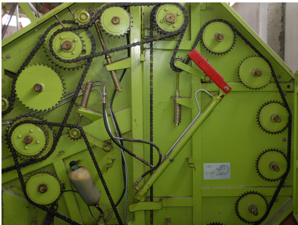
Εικόνα 5.10 Πλάγια όψη χορτοδετικής κυλινδρικών δεμάτων. Οι 11 αλυσοτροχοί που φαίνονται στην περιφέρεια από την πίσω πλευρά (δηλ. την εσωτερική πλευρά της χορτοδετικής) φέρουν κατάλληλα διαμορφωμένα τύμπανα, μέσα στα οποία συμπιέζεται το χόρτο. Όταν η πίεση στο θάλαμο είναι η ενδεδειγμένη, δίνεται η εντολή στον υδραυλικό κύλινδρο να ανοίξει την έξοδο για την απομάκρυνση του δέματος.
