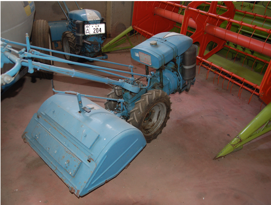
Εικόνα 5.2 Χειροκίνητη φρέζα (φέρει άξονα στο άκρο του οποίου υπάρχουν περιστρεφόμενες λεπίδες για την αναμόχλευση του εδάφους. Ο χειριστής του μικρού αυτού μηχανήματος οδεύει (δηλ. περπατάει) πίσω από αυτό.
