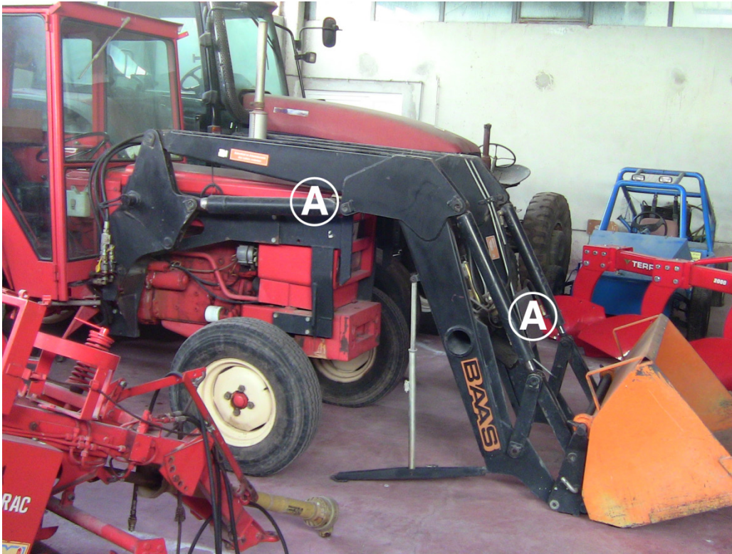
Εικόνα 5.17 Στο γεωργικό ελκυστήρα Renault 651 του Εργαστηρίου Γεωργικών Μηχανημάτων υπάρχουν επιπλέον υδραυλικοί κύλινδροι (Α). Έτσι είναι δυνατός ο έλεγχος της κίνησης του κάδου που έχει προσαρμοστεί στο μπροστινό μέρος του γεωργικού ελκυστήρα για τη μεταφορά υλικών.
