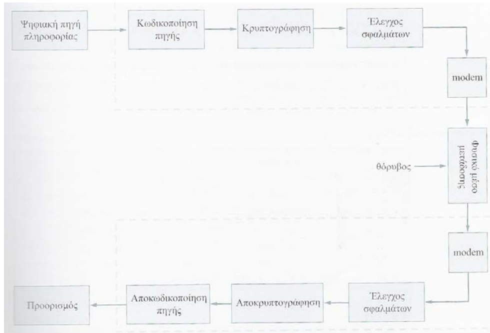
Σχήμα 1. 2: Γενικό Διάγραμμα ενός Ψηφιακού Επικοινωνιακού Συστήματος
