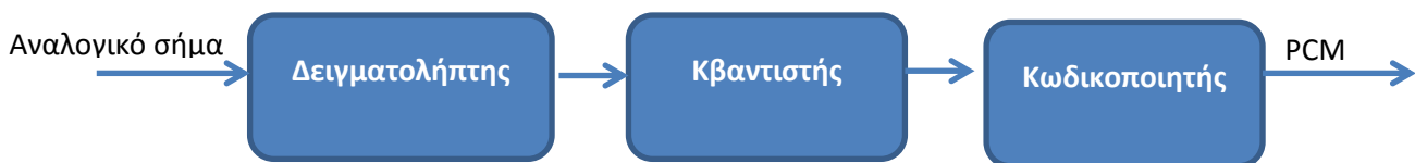
Σχήμα 1: Βασικές επεξεργασίες στην παλμοκωδική διαμόρφωση PCM
