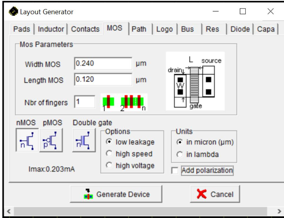
Επιλέξτε Generate Device και κάνοντας κλικ με το αριστερό πλήκτρο του ποντικιού στο περιβάλλον εργασίας του συντάκτη, εμφανίζεται ένα τρανζίστορ NMOS με τις διαστάσεις καναλιού που έχουν επιλεγεί ( $W=0.24 \mu\text{m}$  και  $L=0.12 \mu\text{m}$ ). Στην πηγή (source) και στην υποδοχή (drain) του τρανζίστορ έχουν τοποθετηθεί επαφές και γραμμές διασύνδεσης μετάλλου, έτσι ώστε να είναι δυνατή η σύνδεσή του με άλλα στοιχεία σε ένα κύκλωμα.
