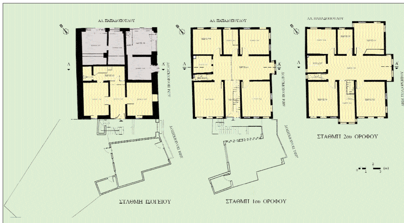
3. Χρήσεις ανά στάθμη (ισόγειο, α΄ όροφο, β΄ όροφο) ■ Επαγγελματικοί χώροι, αποθήκες ■ Κατοικία
