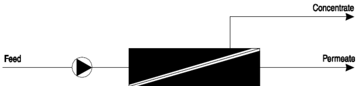
Εικόνα 42: Διεργασία αντίστροφης ώσμωσης συνεχούς ροής (Solutions, 2010)
