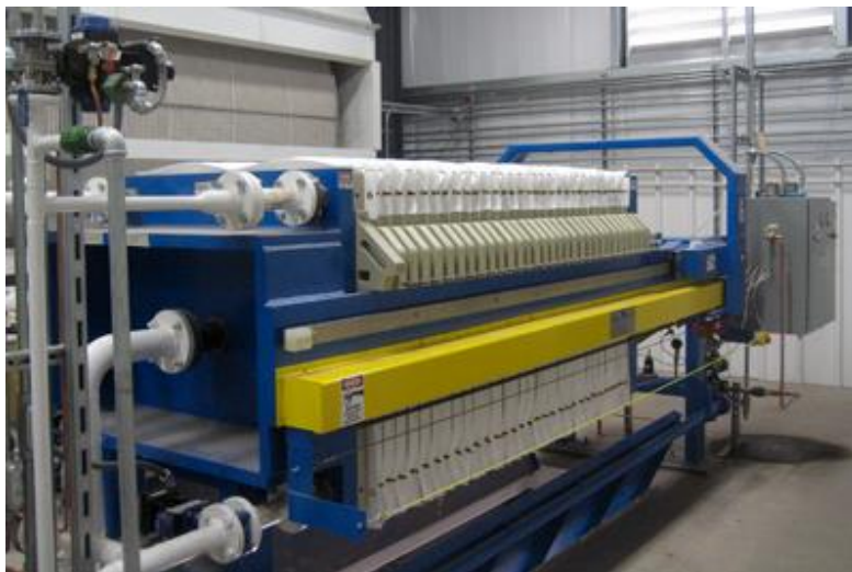
Εικόνα 37: Διάταξη μεμβρανών με επίπεδα φύλλα (πλάκες και πλαίσια). Πηγή: ErtelAlsop
