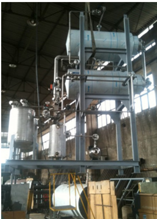
Σύστημα επεξεργασίας άλμης στην πειραματική μονάδα της Τήνου
