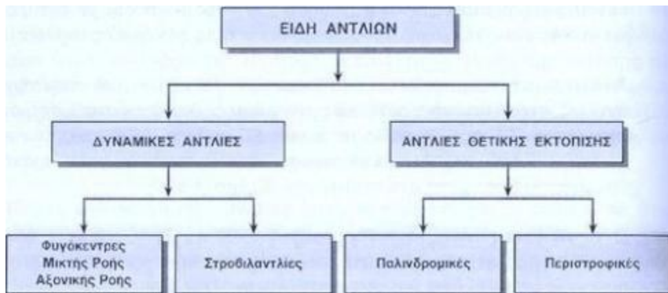
Εικόνα 5.1 Οι τύποι αντλιών με τις υποκατηγορίες τους. Διακρίνονται σε δυο μεγάλες κατηγορίες, τις δυναμικές αντλίες και τις αντλίες θετικής εκτύπωσης.
