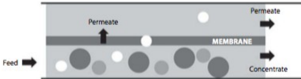
Εικόνα 1.9.3 Η διήθηση διασταυρούμενης ροής είναι μια συνεχής διαδικασία που παράγει δύο ρεύματα εκροής μέσω μιας πηγής τροφοδοσίας
