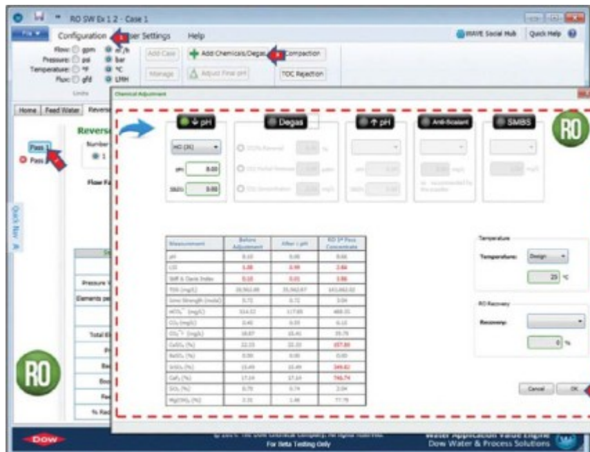
Εικόνα 6.4.1 Χημική ρύθμιση στο WAVE για την αντίστροφη ώσμωση
