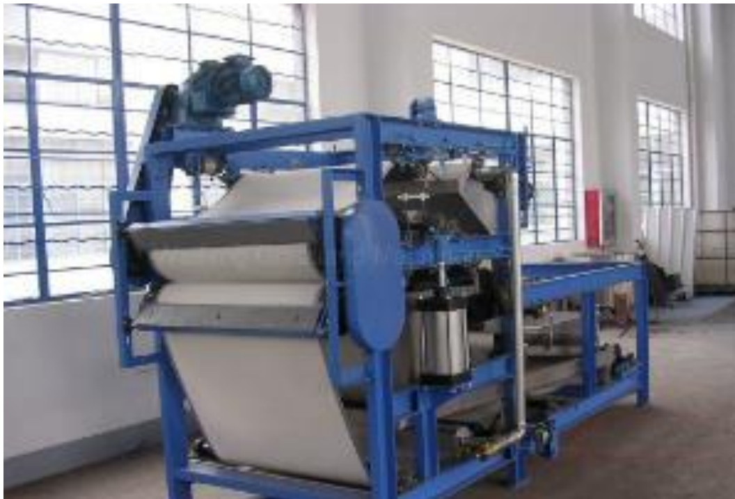
Εικόνα 3.9 Αφυδάτωση με ταινιοφιλτροπρέσσα
