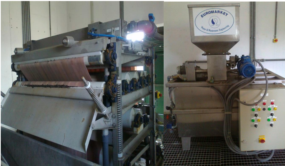
Εικόνα 4.33 Ταινιοπρέσσα για αφυδάτωση ιλύος και Εικόνα 4.34 Συσκευή για την προεπεξεργασία αφυδάτωσης με πολυηλεκτρολύτες
