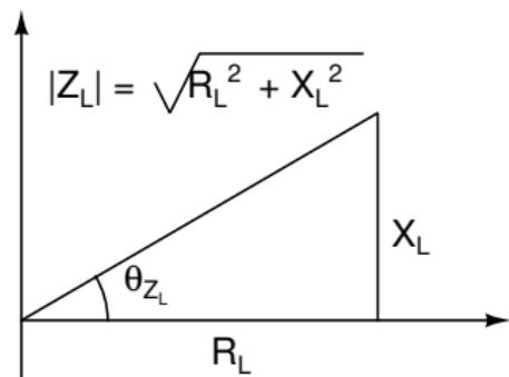
Στο αριστερό τμήμα του σχήματος βλέπουμε το ισοδύναμο κατά Thevenin ενός οποιουδήποτε γραμμικού κυκλώματος ενώ στο δεξιό τμήμα του σχήματος, έχουμε την απεικόνιση στο μιγαδικό επίπεδο του φορτίου  $Z_L$ .
