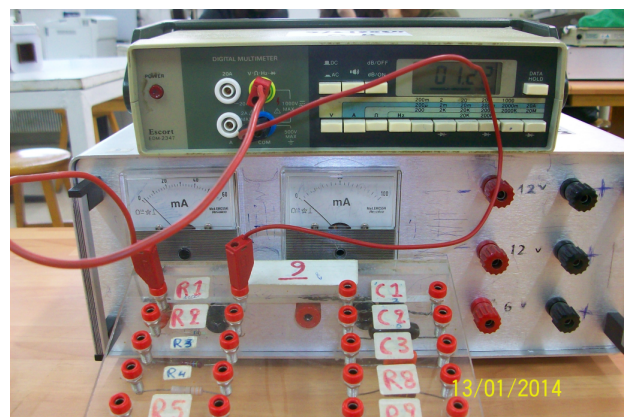
Σχήμα 3: Μέτρηση μεμονωμένης αντίστασης με το φορητό πολύμετρο καθώς και με το πολύμετρο του εργαστηρίου. Το φορητό πολύμετρο μας δείχνει άμεσα αν πρόκειται για Ω ή kΩ ενώ στο επιτραπέζιο πρέπει να επιλέξουμε την κατάλληλη κλίμακα.
