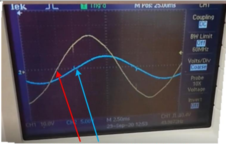
Η μεταξύ τους απόσταση είναι η γωνία έναυσης \alpha όπου στην προκειμένη περίπτωση ισούται με ένα κουτάκι δηλαδή \alpha=45^\circ
