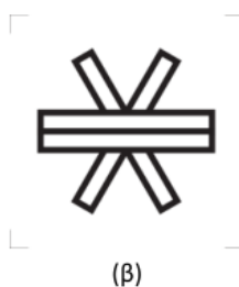
Σχήμα 26: (α) Μετρητές συντελεστή ισχύος, (β) σύμβολο.
