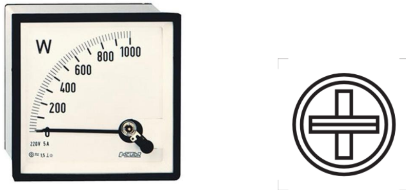
Σχήμα 5: Ηλεκτροδυναμικό βαττόμετρο και σύμβολο.
