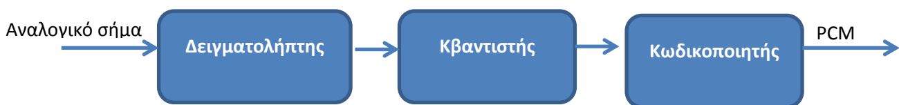
Σχήμα 1: Βασικές επεξεργασίες στην παλμοκωδική διαμόρφωση PCM
