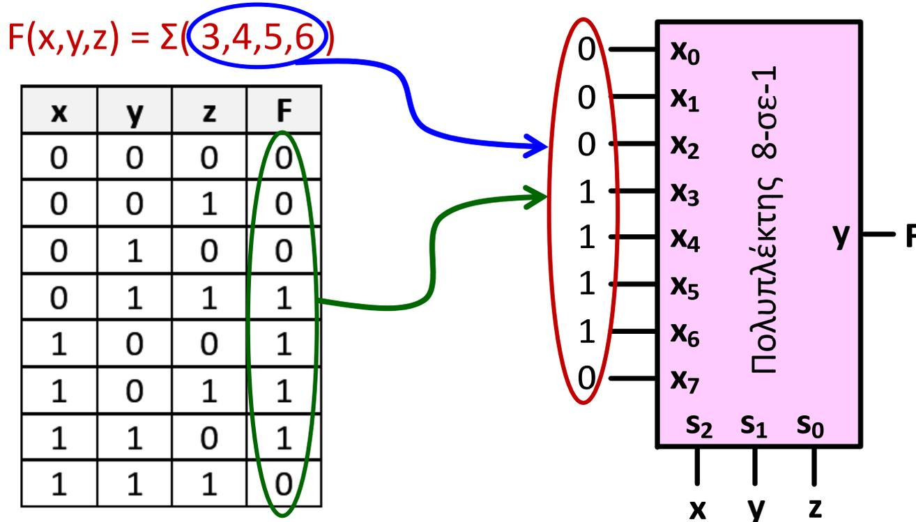
Πρόκειται για συνάρτηση με  $N = 3$  μεταβλητές, επομένως με βάση τα προαναφερόμενα υλοποιείται με έναν πολυπλέκτη  $2^3$ -σε 1 (8-σε-1).
