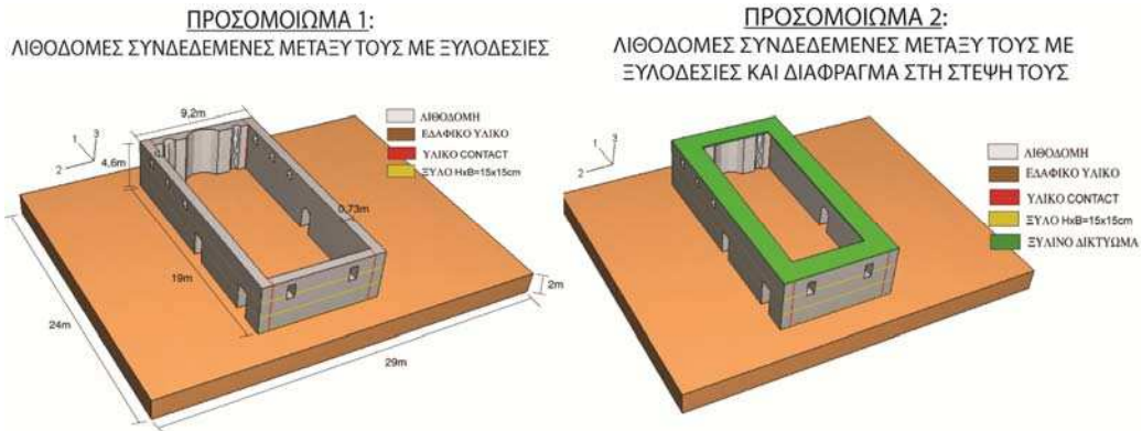
Εικ.21: Γεωμετρικά στοιχεία και υλικά προσομοιωμάτων 1 και 2
