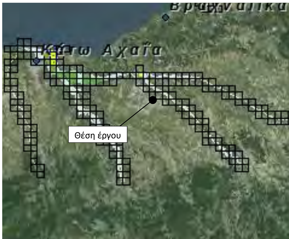
Εικόνα 8.2. Αξιολόγηση επιπτώσεων πλημμύρας για T=50 έτη - ΖΔΥΚΠ GR02RAK0008 - Πεδινή ζώνη λεκανών απορροής Πείρου – Βέργα – Πηνειού –Γλαύκου
