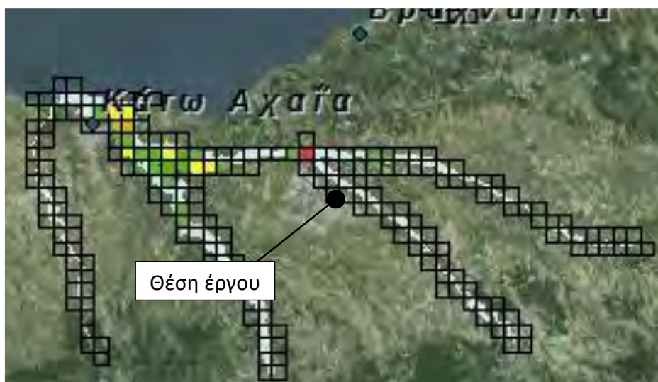
Εικόνα 8.4. Αξιολόγηση επιπτώσεων πλημμύρας για T=1000 έτη - ΖΔΥΚΠ GR02RAK0008 - Πεδινή ζώνη λεκανών απορροής Πείρου – Βέργα – Πηνειού –Γλαύκου
