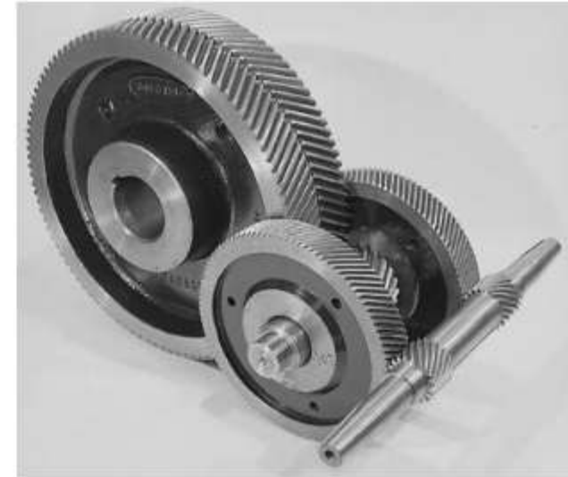
Μετωπικοί οδοντωτοί τροχοί με τοξοειδή οδόντωση
