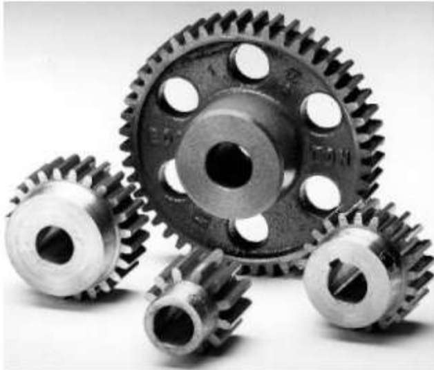
Μετωπικοί οδοντωτοί τροχοί με ευθεία οδόντωση
