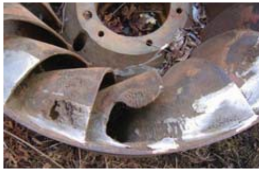
Σχήμα 3.4: Δημιουργία κοιλοτήτων και τελικά απώλειες υλικού στα πτερύγια στροφείων
