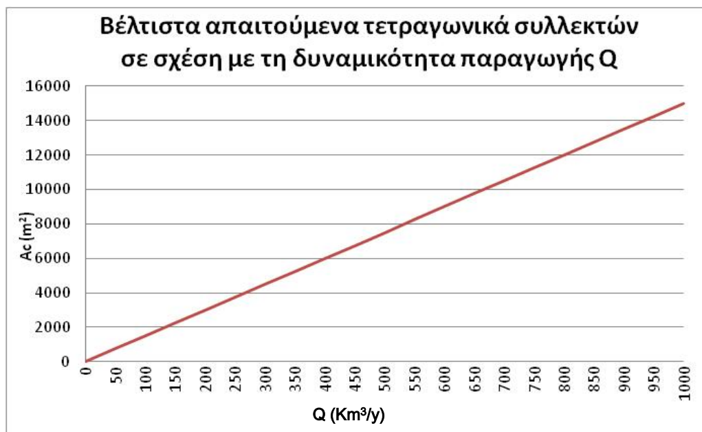
Σχήμα. 16 Βέλτιστα απαιτούμενα τετραγωνικά συλλεκτών σε σχέση με τη δυναμικότητα παραγωγής
