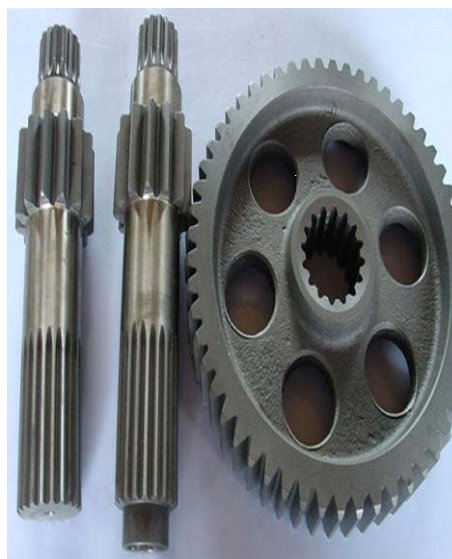
Σύνδεση οδοντωτού τροχού με πολύσφηνο
