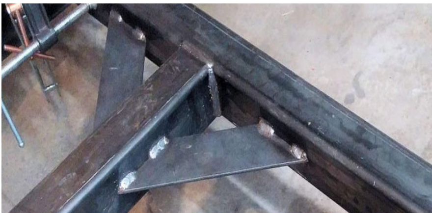
Συγκόλληση κοιλοδοκών με ενισχυτικά νεύρα
