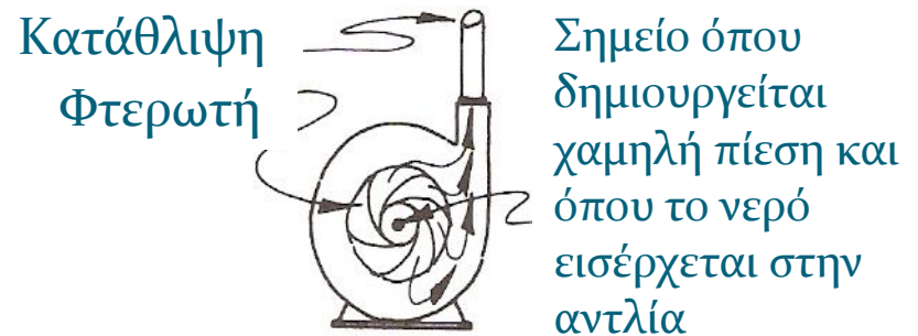
Πρόσθια όψη του θαλάμου και της φτερωτής
