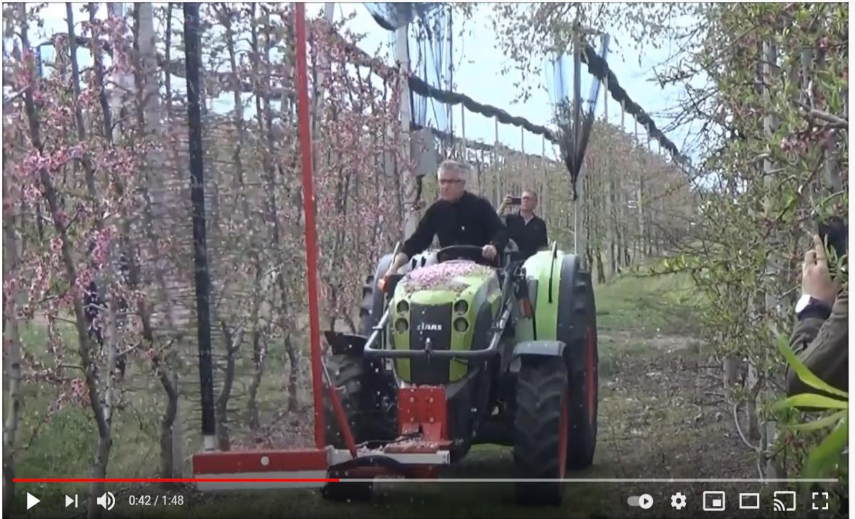
Επίδειξη μηχανικού αραιώματος ανθέων ροδακινιάς σε ελληνικό οπωρώνα (Ημαθία)
