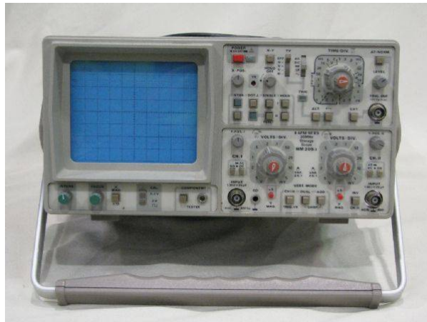
Σχήμα 29: Παράδειγμα βασικού παλμογράφου HAMEG 205-3 που βασίζεται σε καθοδικό σωλήνα. Έχει δυνατότητα ταυτόχρονης απεικόνισης δυο σημάτων τάσης (κανάλι I και II).
