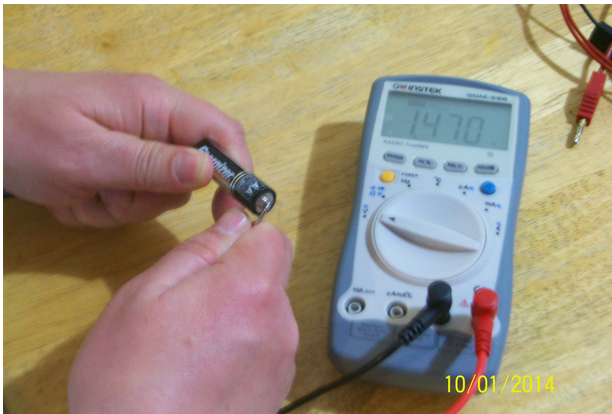
Σχήμα 2: Μέτρηση τάσης μιας κοινής AA μπαταρίας, επάνω και μέτρηση τάσης πηγής συνεχούς (εσωτερική μπαταρία σε αλουμινένιο κουτί) κάτω, με το πολύμετρο του εργαστηρίου. Στη δεύτερη περίπτωση μετρούμε τάση 12.81 V και παρατηρούμε από την πολικότητα των probes του οργάνου ότι κάποιος ασκούμενος φοιτητής έχει λανθασμένα σημειώσει με στυλό την πολικότητα της πηγής στο κουτί.
