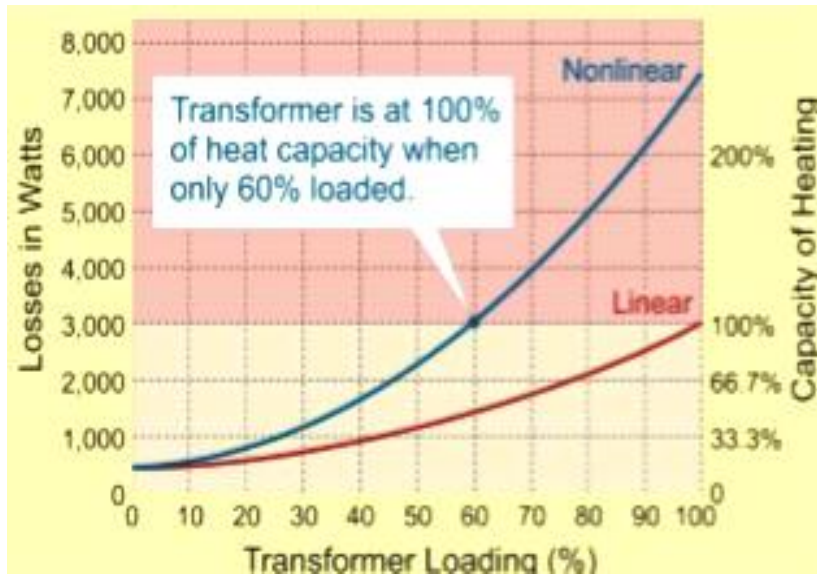
Σχήμα 14 Απώλειες θερμότητας & ποσοστό θερμικής χωρητικότητας στάνταρ Μ/Σ.
