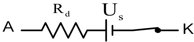
Σχήμα 1.4: Απλοποιημένο ισοδύναμο του θυρίστορ
