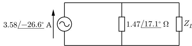
Σχήμα 32: Τελικό κύκλωμα με συνδυασμό της 4 Ω.
