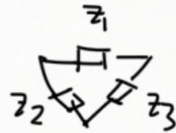
$$Z_1 = \frac{Z_4 R_3 + R_3 Z_{C1} + Z_{C1} Z_{L1}}{Z_{C1}}$$
