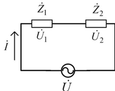
$$\dot{U}_1 = \dot{i}_1 \dot{Z}_1, \dot{U}_2 = \dot{i}_2 \dot{Z}_2 \text{ και } \dot{U} = \dot{i} (\dot{Z}_1 + \dot{Z}_2)$$
